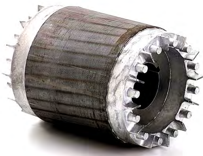
Rotor lồng sóc bằng nhôm sau khi đúc
